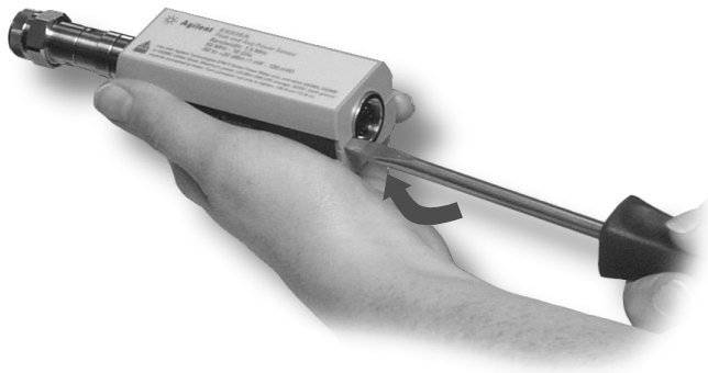
Abbildung 12 Abnehmen des Leistungsmesskopfgehäuses
